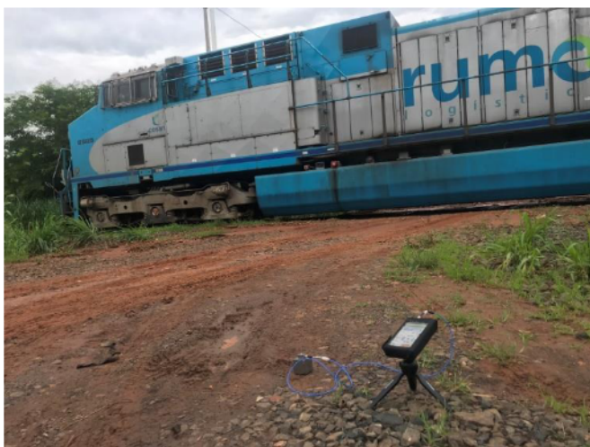
Figura 6 – Medição de Vibração com passagem do trem.
