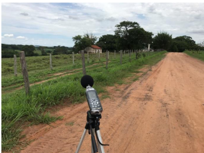
Figura 5 – Medição de Ruídos no futuro eixo do projeto.
