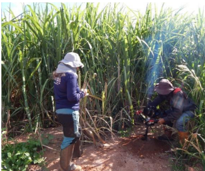
Figura 46 – Execução do furo de tradagem F398.
